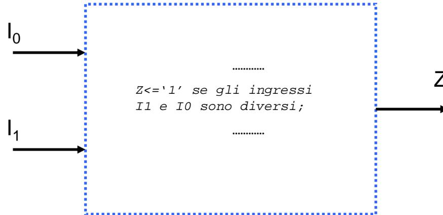
Nella rappresentazione strutturale (*'Structural'*) un componente e' descritto connettendo tra loro più blocchi. L'approccio e' basato su un linguaggio testuale (VHDL) ma risulta concettualmente analogo al design-entry mediante schema logico.
